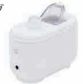
塩タブレット（品目コード：080200-0751）を溶かした蒸留水を噴霧することで測定環境中の粒子数を増やし、労研式マスクフィッティングテスターによる合否判定を適切にします。
