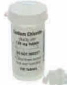
労研式マスクフィッティングテスターによるマスクの漏れ率測定時に、測定環境中の粉じん粒子数を増やす目的で使用します。
